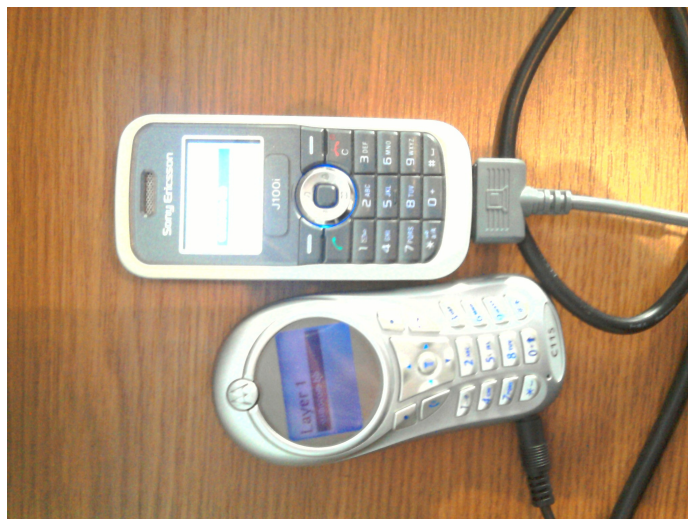
Slika 9: Strojna oprema za zajem in analizo GSM podatkov.
