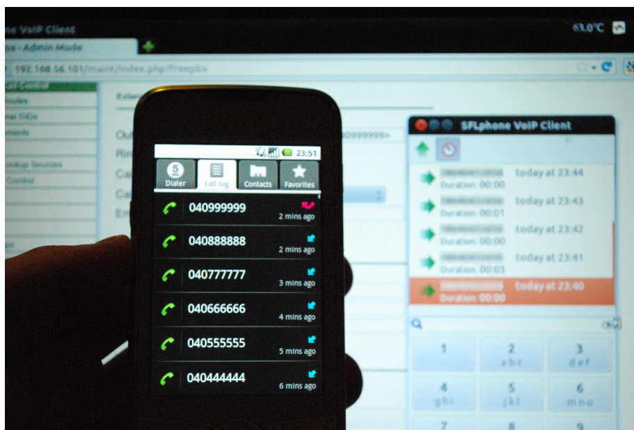
Slika 7: Prikaz prejetih klicev na mobilnem telefonu. V ozadju vmesnik za spreminjanje nastavitev telefonske centrale in programski telefon SFL Phone.
